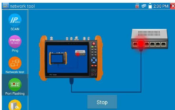
Если тестер и PoE - коммутатор подключены правильно, порт LAN PoE-коммутатора начнет мигать с определенной частотой, если нет, никаких изменений в поведении порта коммутатора наблюдать не будет.
