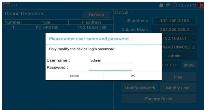
**Сброс к заводским настройкам:** камера будет сброшена, а имя пользователя, пароль и сетевые настройки устройства будут сохранены. Другие данные настроек сбрасываются.
