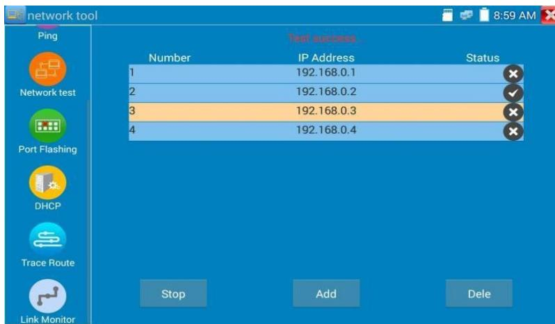
Добавьте IP-камеру или другое сетевое устройство в текущую сетевую группу, новый IP-адрес не должен быть занят, иначе это вызовет конфликты IP и остановит работу оборудования. Link Monitor может проверить, занят ли конкретный IP-адрес.
