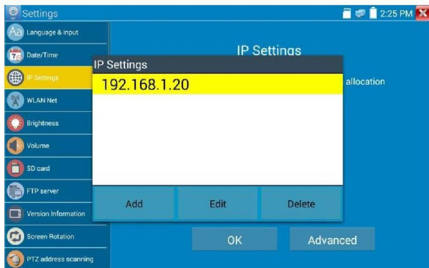
После установки расширенного IP-адреса (см. Фото выше), устройство может протестировать два сегмента сети (192.168.5.0) и (192.168.1.0) **WLAN Net**: отключение или включение Wi-Fi
