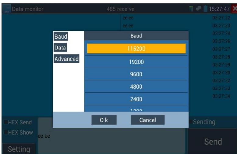
Нажмите «Настройка», чтобы выбрать скорость передачи данных по RS485; он должен быть таким же, как DVR или клавиатура Control.DVR или Control клавиатура отправляет код тестеру, если его можно прочитать, протокол будет показан в правом верхнем углу, например, Pelco D, если нет, например, P: ---
