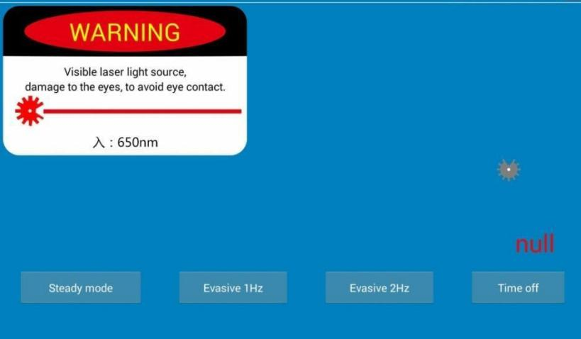
VFL может выбирать четыре режима: Steady Mode, «Evasive 1 Гц», «Evasive 1 Гц» и «Steady Mode». Нажмите кнопку «Steady Mode», чтобы войти в режим постоянного сигнала, нажмите кнопку «Evasive 1 Гц» и «Evasive 2 Гц», чтобы войти в режим импульсов, нажмите кнопку «Time Off» для задания интервала времени. Можно выбрать интервал (5 минут, 10 минут, 30 минут, 60 минут и 120 минут).
