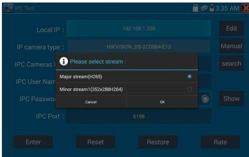
**IP-адрес камеры:** введите IP-адрес IP-камеры вручную или нажмите «Поиск» для автоматического сканирования IP-адреса камеры. Лучше напрямую (не через коммутатор) подключить IP-камеру к тестеру, чтобы результаты поиска отображали только IP-адрес камеры. Если тестер подключен к коммутатору PoE, он, возможно, найдет и отобразит несколько IP-адресов.
