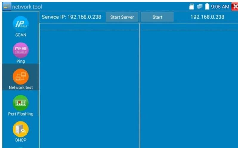
Для тестирования необходимо иметь тестер или компьютер, на котором установлено Сетевое тестовое программное обеспечение, в качестве СЕРВЕРА, другой тестер осуществляет посылку пакетов на сервер(пакетный тест). Оба устройства должны находиться в одном сетевом сегменте.
