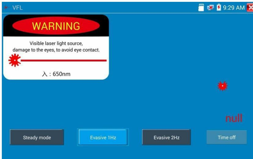
Нажмите значки «Evasive 1Hz» или «Evasive 2Hz» для входа в импульсный режим, лазерный источник начнет генерировать импульсные сигналы.
