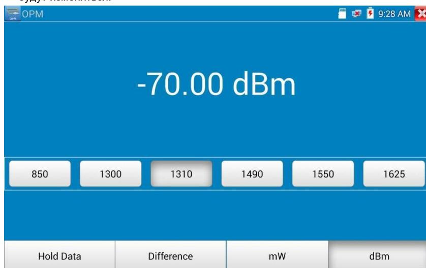
Измерение относительной мощности (потери оптической линии)
