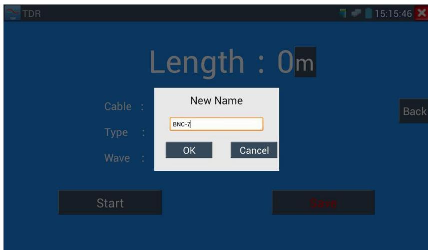
**Применение:** Тест TDR - это метод импульсного отражения, передающий импульсный сигнал по тестируемому кабелю. Когда кабель разомкнут или закорочен, генерируется отраженный импульс, тестер принимает и обрабатывает отраженную волну, результаты измерений отображаются на экране. TDR может проверить обрыв цепи и короткое замыкание кабеля, помочь специалисту быстро найти местоположение кабельной проблемы. С его помощью можно удобнее и эффективнее отремонтировать неисправный кабель.
