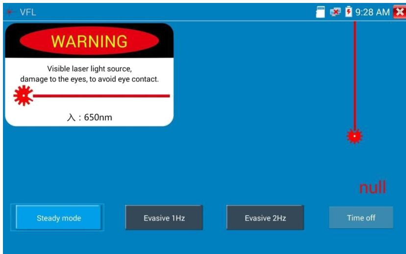
Нажмите «Steady Mode», красный лазерный источник излучает постоянный сигнал, нажмите еще раз, чтобы завершить.
