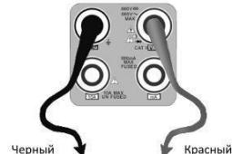
Ручная установка диапазона измерений: (замкните красный и черный щупы между собой, на дисплее отобразится текущий диапазон)
