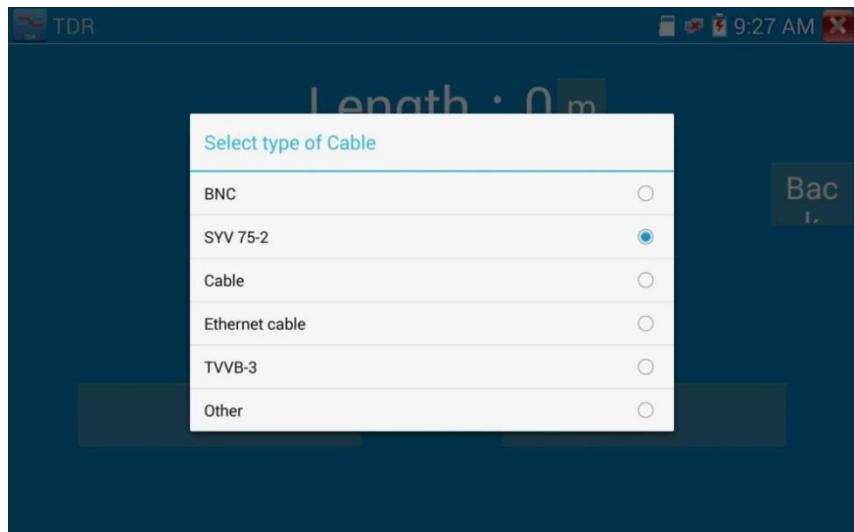
3. Щелкните «+» или «-», чтобы отрегулировать скорость волн, чтобы длина отображения совпала с фактической длиной, нажмите «Сохранить», чтобы сохранить данные калибровки. Их можно использовать для тестирования одного и того же кабеля в следующий раз.
