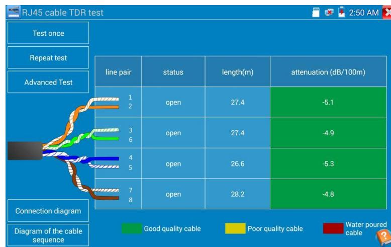
**Однократный тест:** состояние тестового кабеля, длина и затухание.
