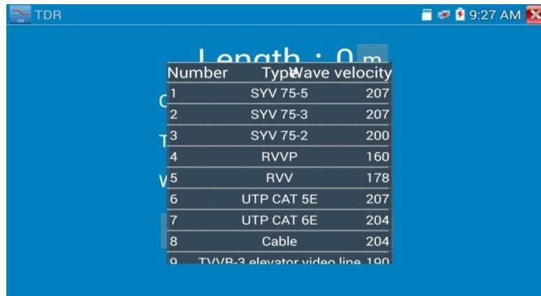
**Калибровка, определяемая пользователем:** выберите кабель от 100 до 200 метров (более 50 метров), нажмите «Кабель», «Тип», чтобы выбрать пользовательский тип 1 для калибровки, можно настроить 11 групп, определенных пользователем.
