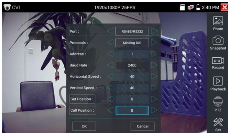
**Управление RS485.** См. Инструкция по эксплуатации, раздел «3.3.1 PTZ
